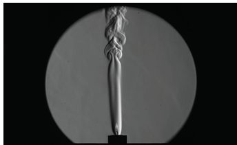
Figura 2: Fotografía de las variaciones de densidad del aire cercano a una vela mediante la técnica Schlieren, desarrollada por Toepler. [9]
