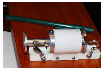
Figura 3: Primer dispositivo láser de Maiman [10]
